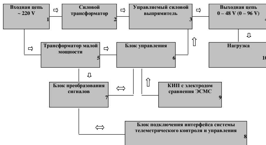
Рис. 20. Блок - схема устройств катодной защиты УКЗТ – АТ:
